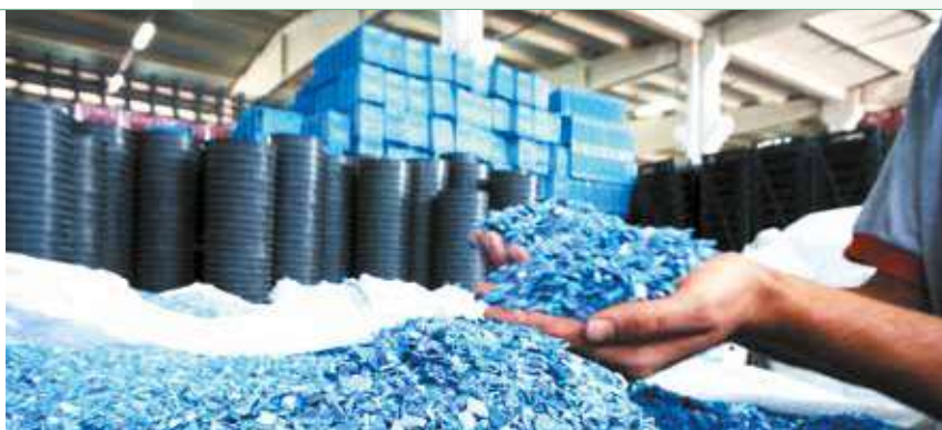
Les plastiques dits légers ou souples (films plastiques, films agricoles, sacs plastiques...) sont déchiqtetés, déferailés puis densifiés. Cette dernière opération permet d'obtenir des granulés.
