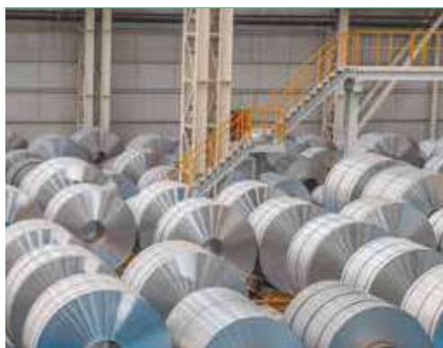
Après avoir été fondu, l'acier est transformé en fines bandes de tôles, enroulées en bobines pouvant atteindre jusqu'à 20km.
